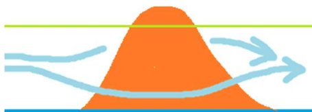
図 3-18-5 カルマン渦の発生模式図 逆転層 (黄色で塗られた層) の上に山頂が突き出ており、逆転層下の風は山を迂回している
