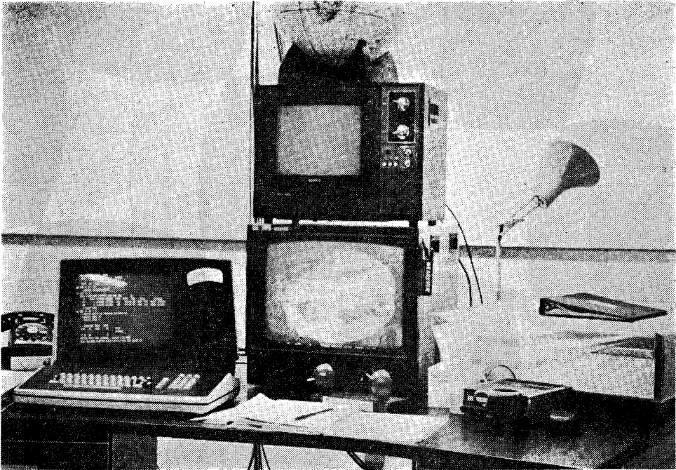
第13図 McIDAS 計算機室の向い648号室にある McIDAS ターミナル。左側が文字表示のための CRT, 中央に TV 型表示器, その手前に2個のジョイスティックが見える。右側はビデオテープレコーダ, 中央上部はテレビで通常は使われていない。右手前(コーヒー茶わんの後)は McIDAS オペレータとの通信用インターホン。
