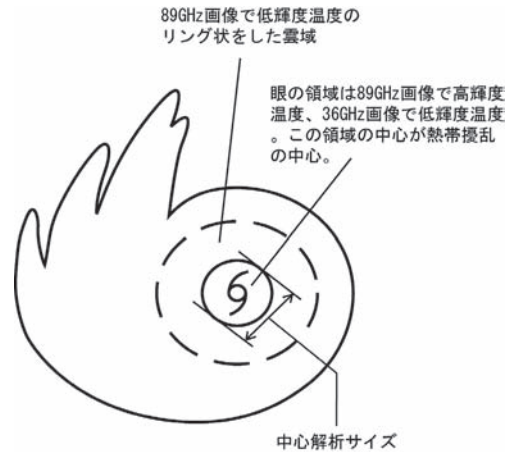
図 14-1 完全なリング状 EYE パターン
