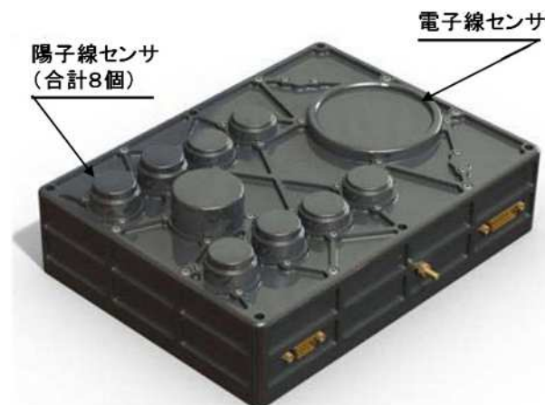
写真2 宇宙環境データ取得装置の外観
