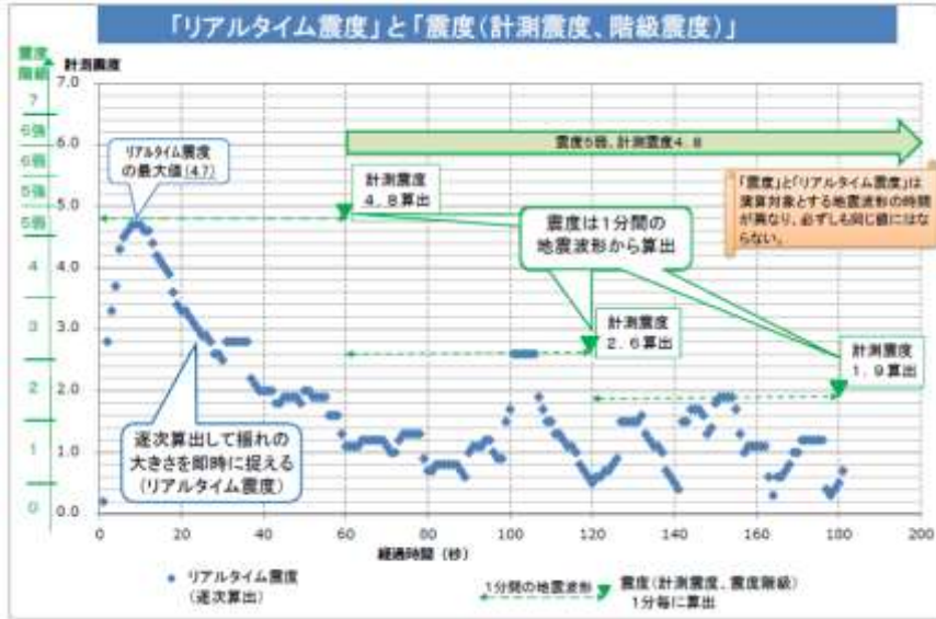
図6：リアルタイム震度と震度（計測震度・階級震度）の算出タイミングの違い
