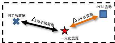
図 1.1 地震発生場所ごとにみた一元化震源に対する旧手法および IPF 法による推定震源(最終解)の震央誤差 [km] 分布
