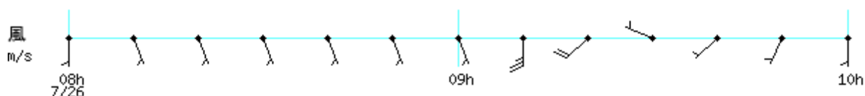
被害発生地域付近のアメダス風向・風速時系列グラフ
