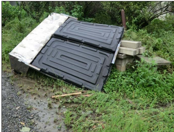
③ 南東に約30m移動した太陽熱温水器 （温水器は地上に置いていた） [藤原町大貝戸]
