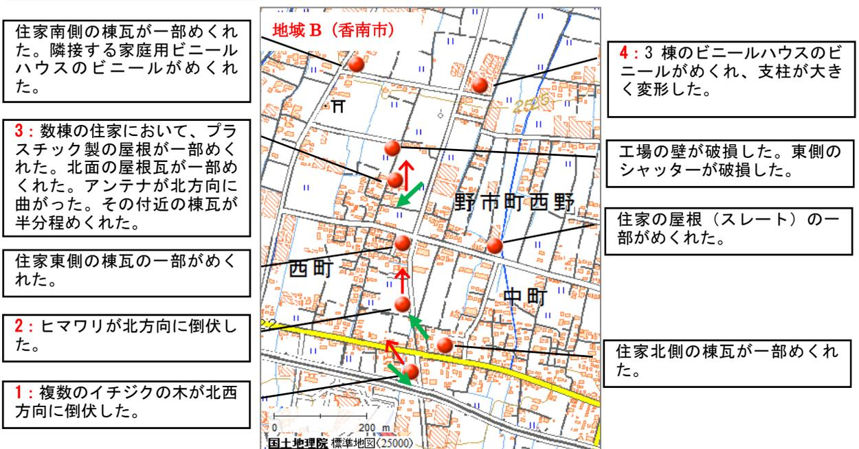
図9 香南市地域Bの被害分布図(図1-2参照)
