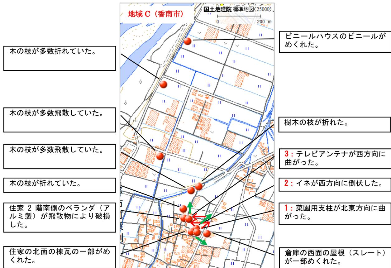
図 10 香南市地域 C の被害分布図（図 1-2 参照）
