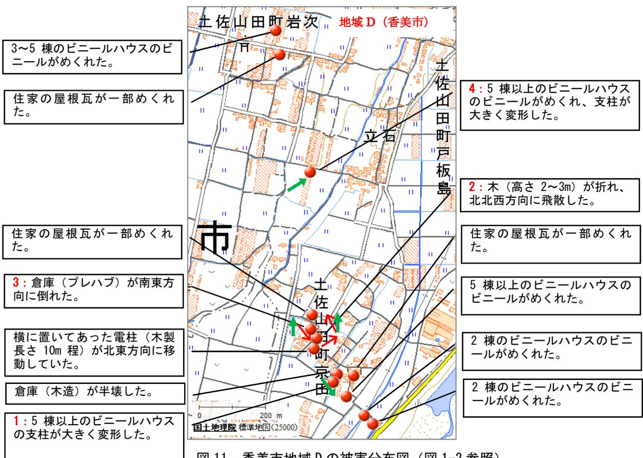
図 11 香美市地域 D の被害分布図（図 1-2 参照）
