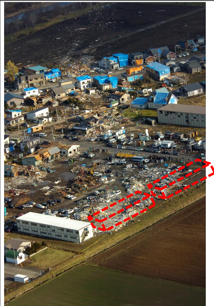
DOD=3 2階建て以上(2連以上)の転倒 手前の飛ばされていない仮設事務所と同じものが2棟(赤点線)飛ばされた。右図は飛ばされた仮設事務所の杭基礎の状況で、杭が引き抜けに対して抵抗した痕跡はない。(2層以上の連棟で短辺長さが10m以上あるので代表値を採用する事例) 写真提供：(左)東京工芸大学風工学研究センター、(右)国立研究開発法人建築研究所
