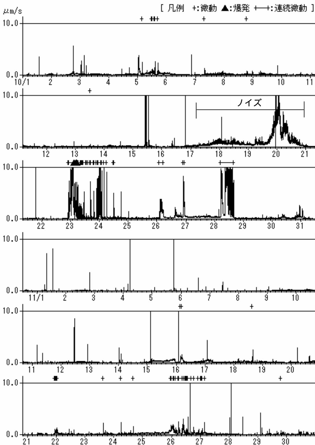
図4 地震計(上下動)の1分間平均振幅の変化(2004年10月1日~11月30日)
