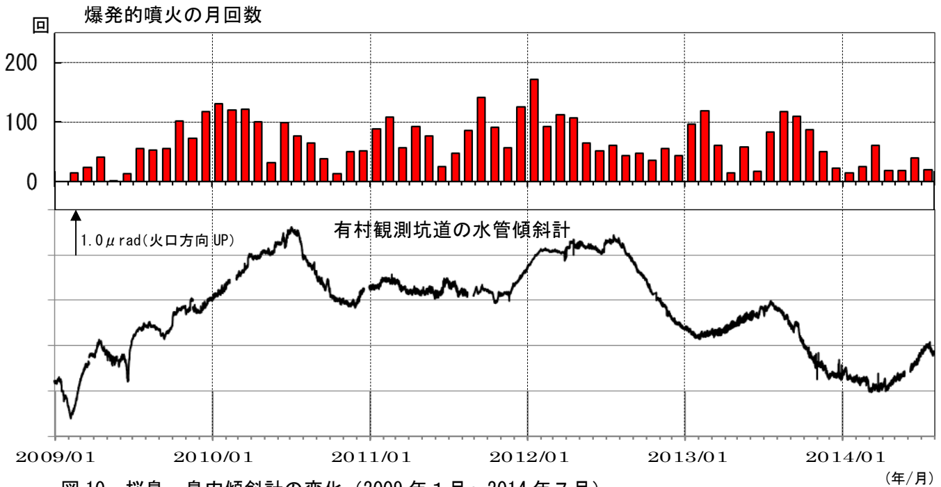
図 10 桜島 島内傾斜計の変化（2009 年 1 月～2014 年 7 月） (下図：有村観測坑道の水管傾斜計（大隅河川国道事務所設置）)
