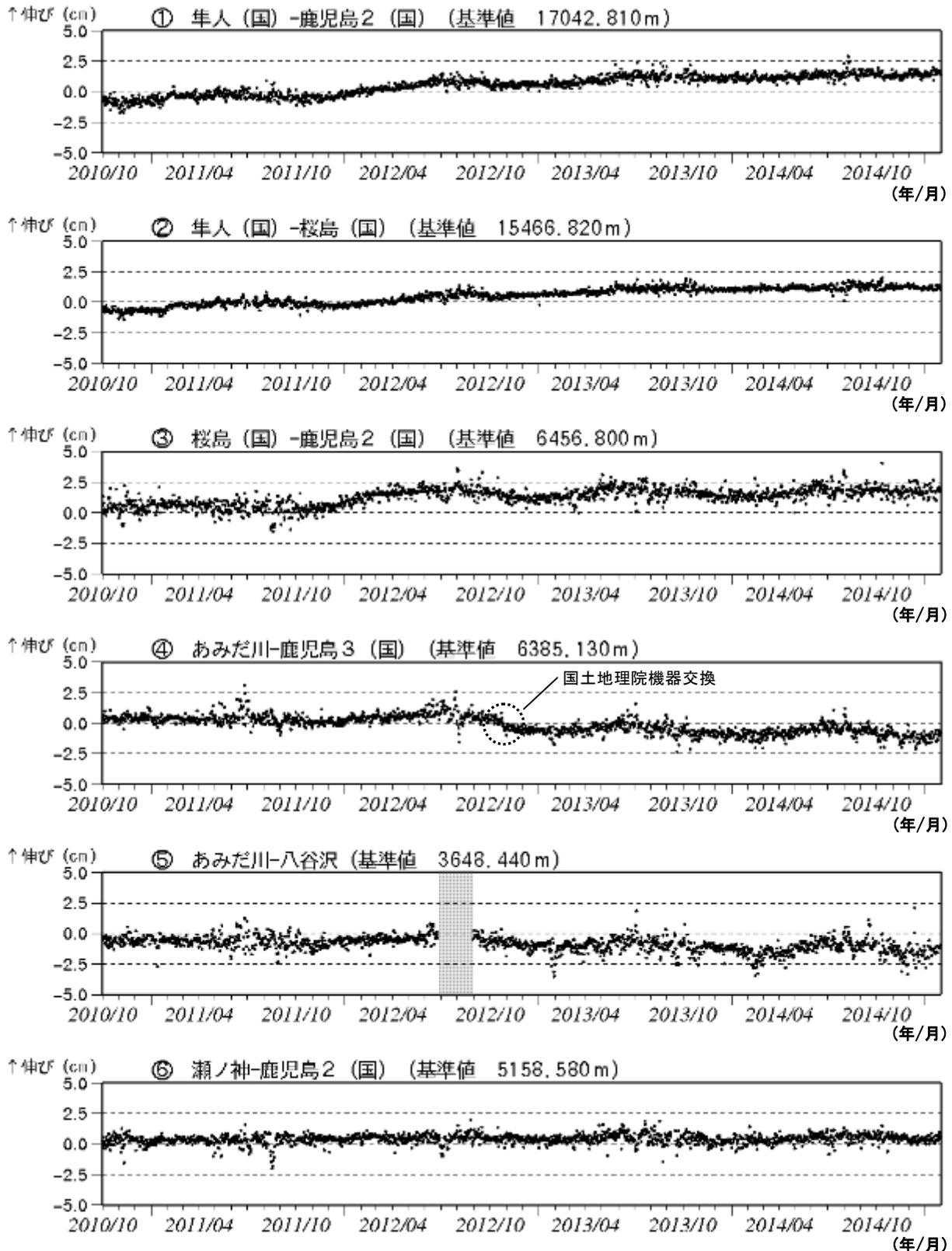
図 11-1 桜島 GNSS 連続観測による基線長変化 (2010 年 10 月～2015 年 1 月)
