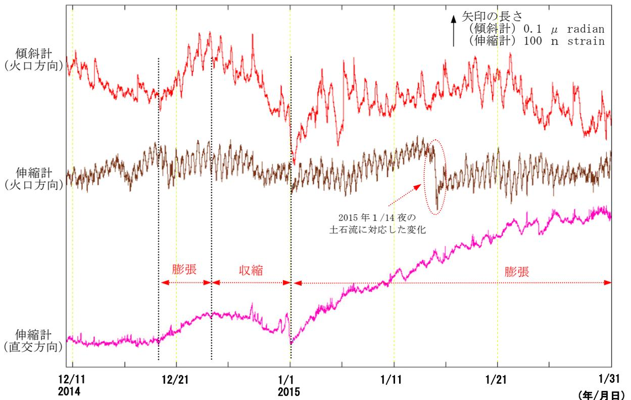
図10 桜島 島内の傾斜計・伸縮計の変化（2014年12月10日～2015年1月）
