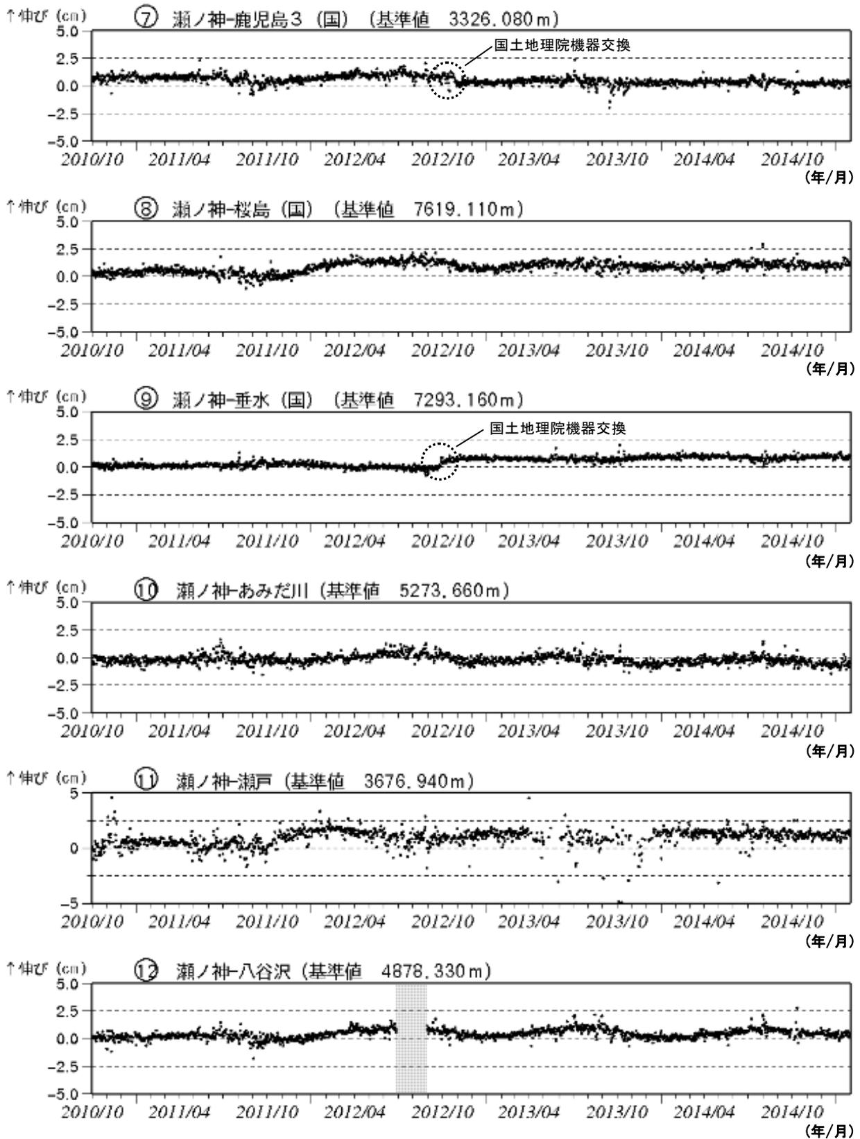
図 11-2 桜島 GNSS 連続観測による基線長変化 (2010 年 10 月～2015 年 1 月)
