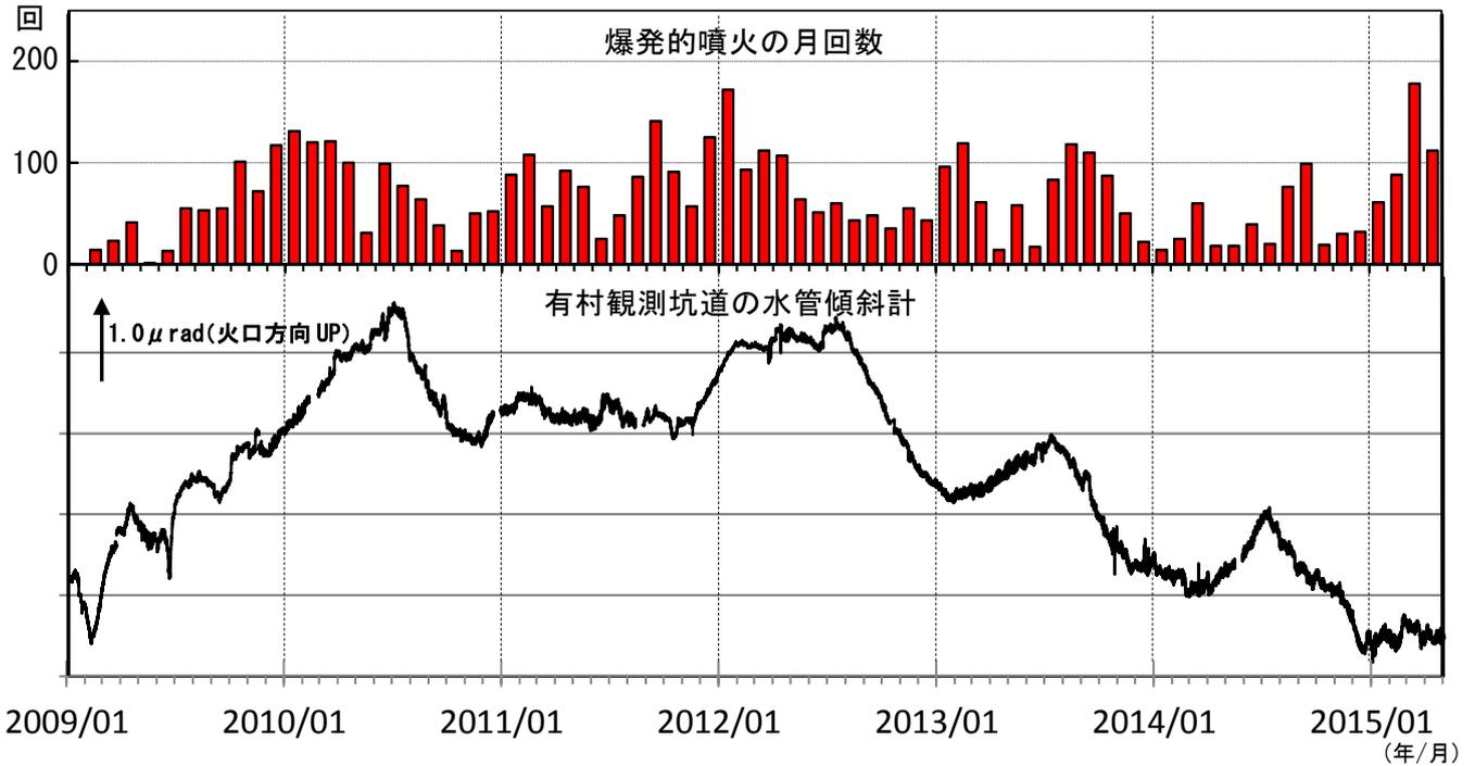
図 11 桜島 島内傾斜計の変化（2009 年 1 月～2015 年 4 月）
