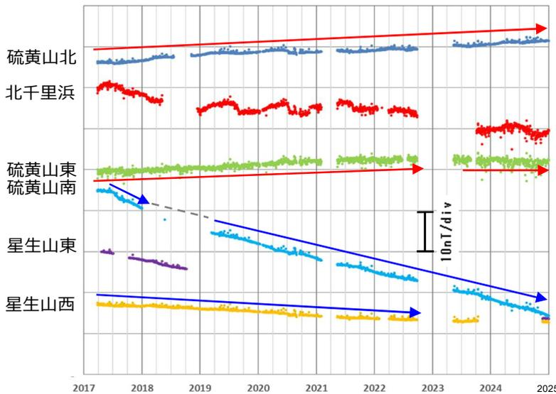
図 5-1 九重山 連続観測による全磁力の変化
