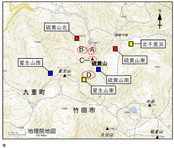
図 4-2 九重山 全磁力観測点配置図及び噴気地帯（A～D領域）の位置
