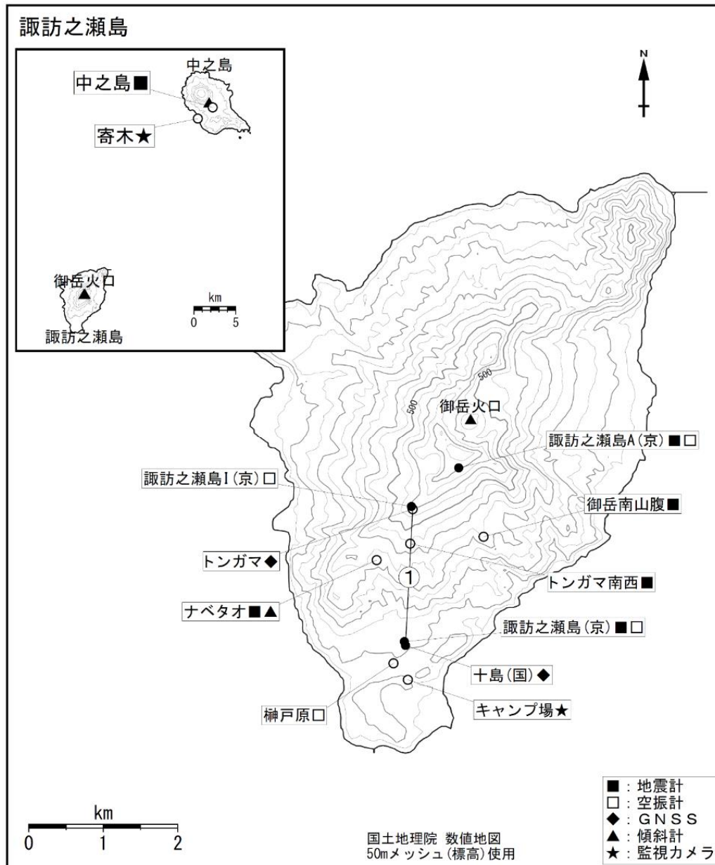
図7 諏訪之瀬島 観測点配置図とGNSS連続観測の基線番号
