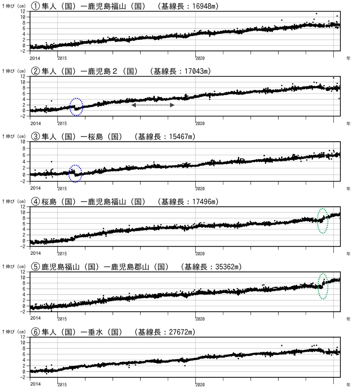
図 7-1 桜島 GNSS 連続観測による基線長変化（2014 年 1 月～2025 年 3 月）
