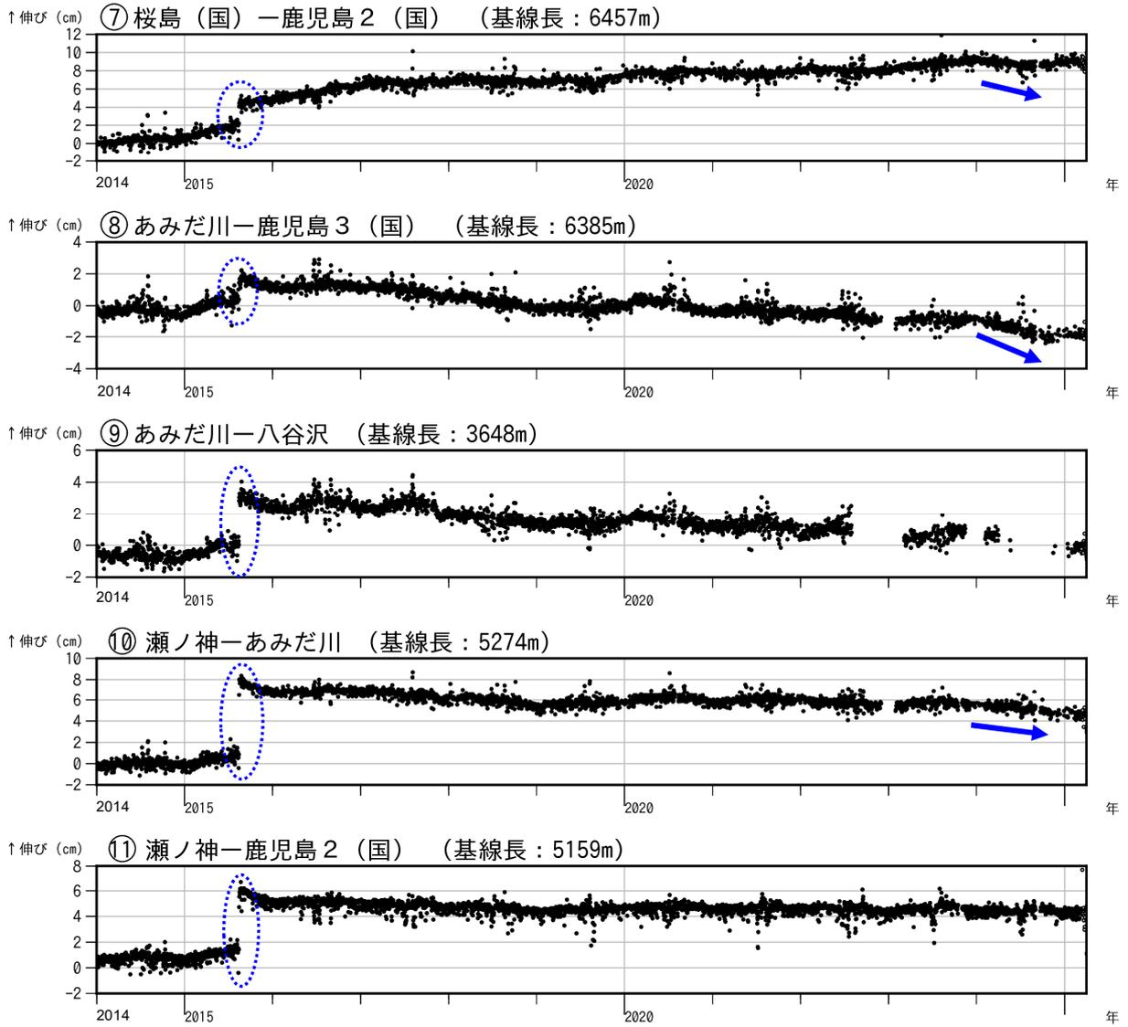
図 7-2 桜島 GNSS 連続観測による基線長変化（2014 年 1 月～2025 年 3 月）
