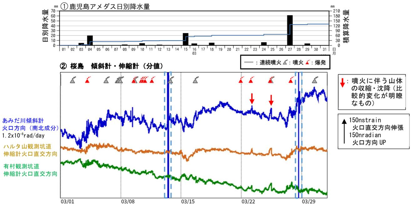
図6 桜島 傾斜計及び伸縮計による地殻変動の状況（2025年3月）
