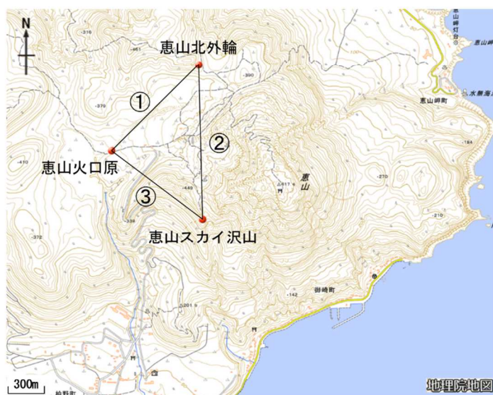
図 12 恵山 GNSS 繰り返し観測による基線長変化及び観測点配置図 (2005 年 8 月～2021 年 10 月) ・ 2019 年から 2020 年に認められた基線長のわずかな伸長の変化は、2021 年 10 月の観測では確認されませんでした。
