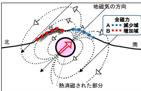
図8 熱消磁に伴う全磁力変化のモデル
