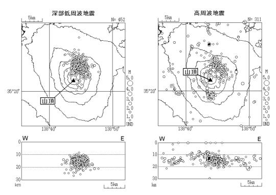
図3 ※ 富士山 深部低周波地震及び高周波地震の震源分布 (上段:震央分布 下段:東西断面)
