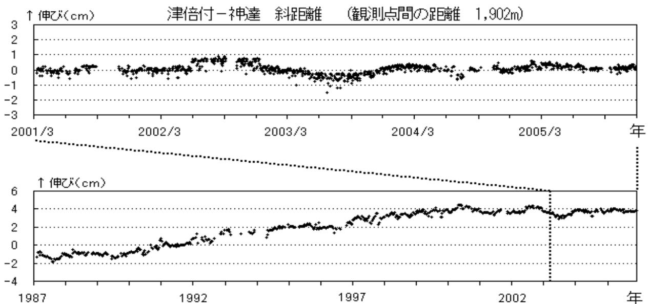
図5 伊豆大島 光距離計による津倍付-神達間の斜距離変化
