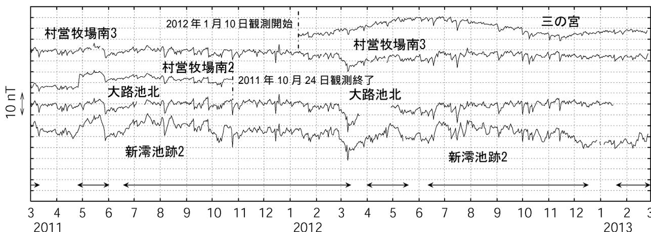
図6 三宅島 全磁力連続観測による全磁力値の変化(2011年3月~2013年2月)
