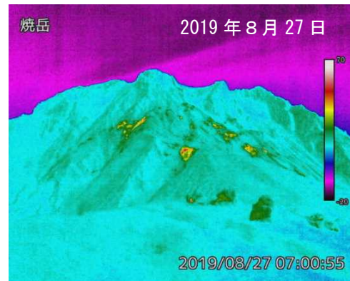
図5 焼岳 中尾峠赤外熱映像カメラによる焼岳の北側斜面の地表面温度分布と可視画像 撮影場所と撮影方向は図10を参照下さい。
