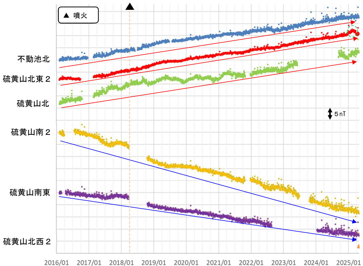
図 6-2 霧島山（えびの高原（硫黄山）周辺） 全磁力観測点で観測された全磁力変動 （2016 年 1 月～2025 年 4 月）
