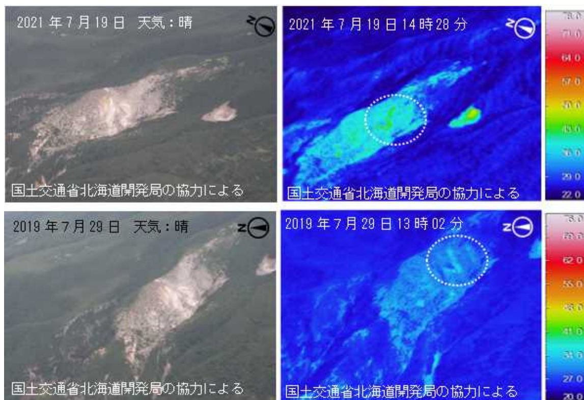
図 4 知床硫黄山 赤外熱映像装置による北西側中腹の爆裂火口の地表面温度分布
