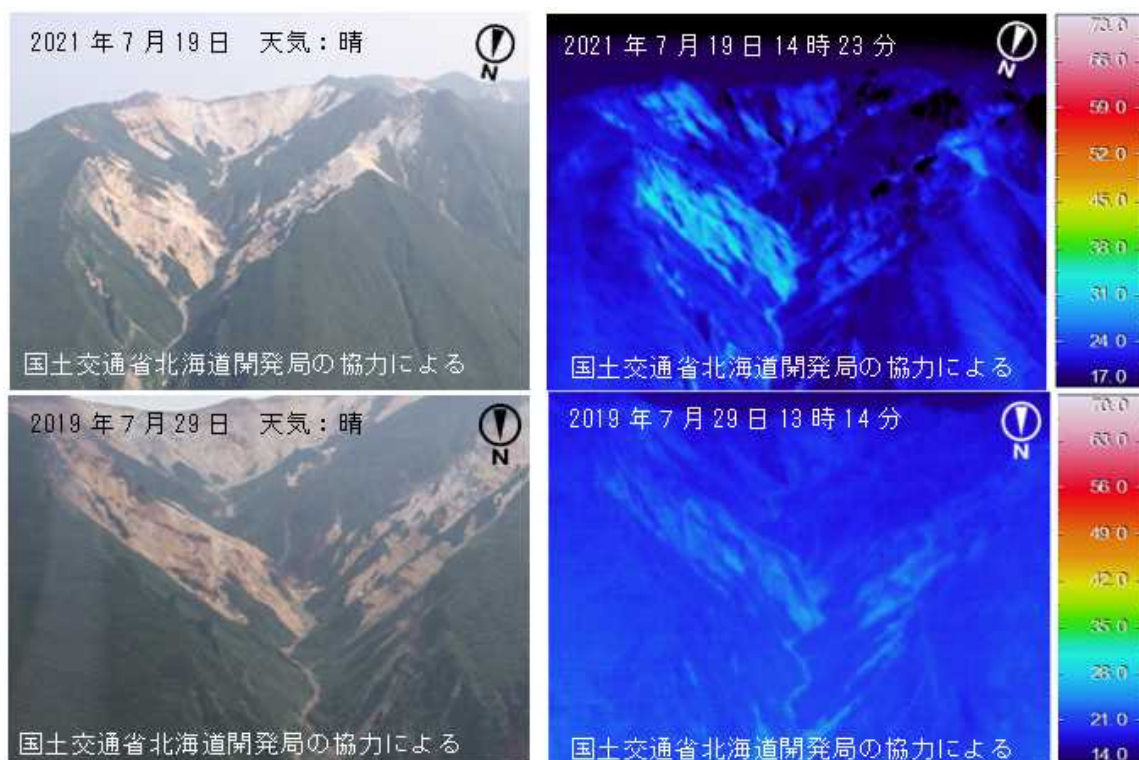
図 5 知床硫黄山 赤外熱映像装置による東岳大火口の地表面温度分布
