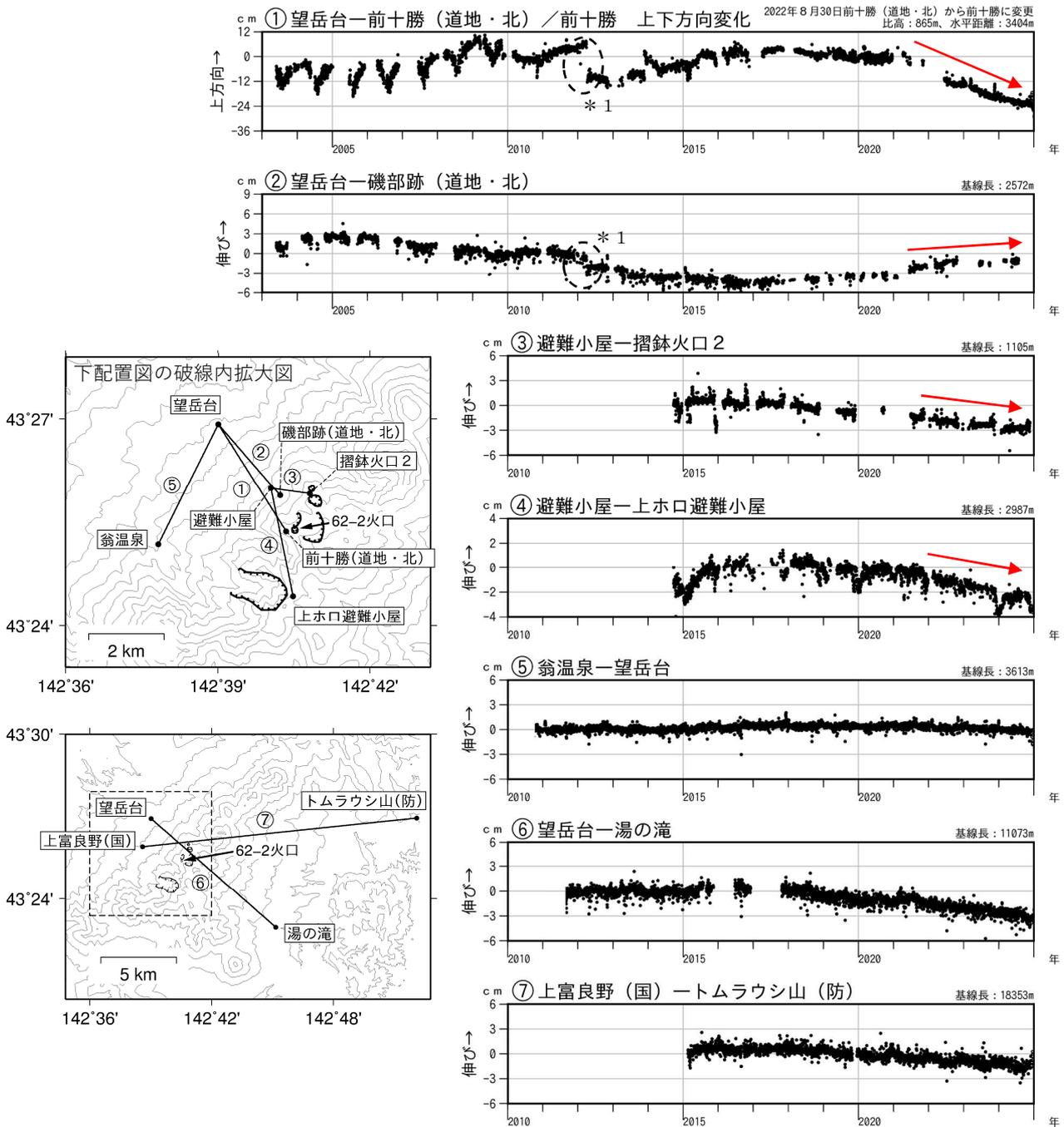
図5 十勝岳 GNSS連続観測による上下方向変化及び基線長変化（2003年5月～2024年12月）及び観測点配置図
