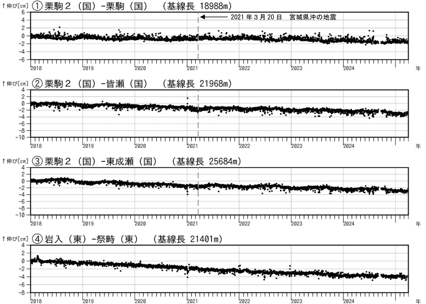
図7 栗駒山 GNSS 基線長変化図（2018年1月～2025年3月）
