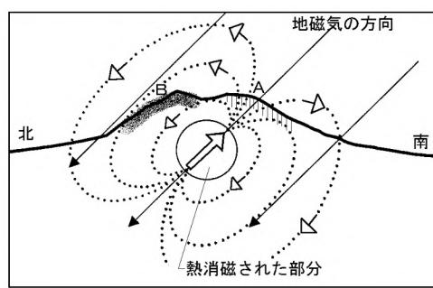
図16 熱消磁に伴う全磁力変化のモデル
