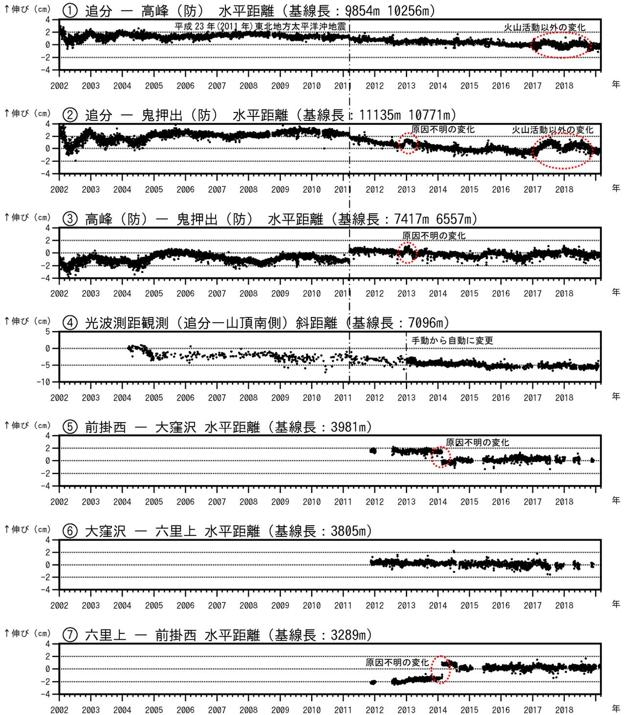
図 7-1 浅間山 GNSS 連続観測及び光波測距観測の結果 (2002 年 1 月 1 日～2019 年 2 月 28 日)
