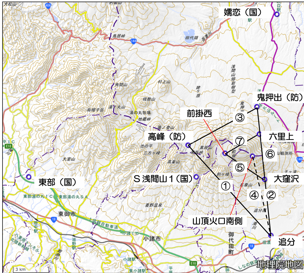
図7 浅間山 地殻変動連続観測点配置図
