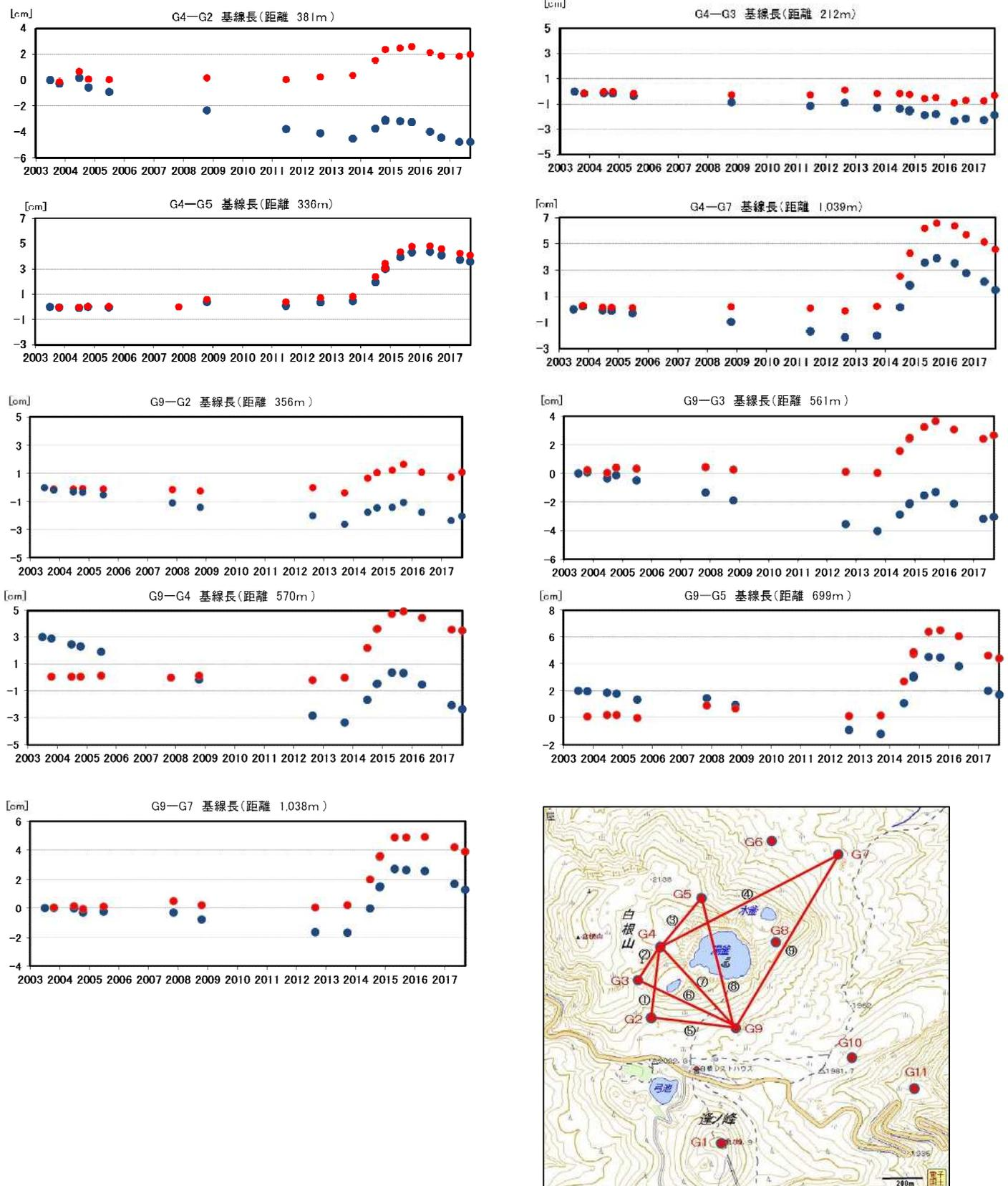
図 10 草津白根山 GNSS 繰り返し観測の基線解析結果（2003 年 7 月～2017 年 9 月）と GNSS 繰り返し観測の基線配置
